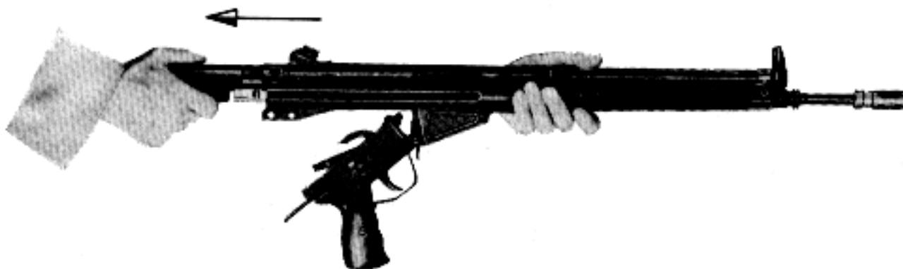
Fig. 64: Remove the bolt
